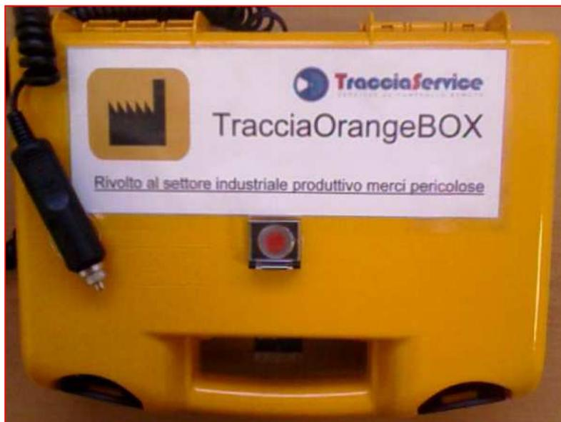
Il dispositivo consiste in una BOX, modalità mobile alimentata tramite la presa dell'accendisigari, o, in caso di necessità, da una batteria interna che le consente un'autonomia di 36h.
